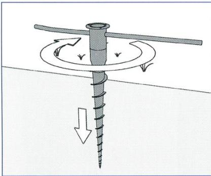
1. Schraubfundament in die Erde schrauben: Eindhrehstange mit dem geknickten Ende (oder beliebige Stange/ Rohr) in die Durchgangsbohrung stecken und das Schraubfundament eindrehen.
